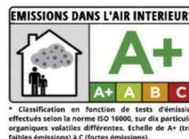
\* Classification en fonction de tests d'émission effectués selon la norme ISO 15000, sur dix particules organiques volatiles différentes. Echelle de A+ (très faibles émissions) à C (fortes émissions).
